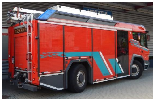
4. számú kép. A Rosenbauer elektromos gépjárműfecskendője kormányzott hátsó kerekekkel. (Pántya Péter, 2022)
