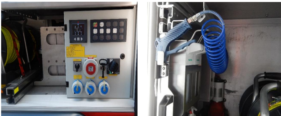
18. és 19. számú képek. Elektromos csatlakozók az egyik málhatérben a különböző tisztításokra is alkalmazható sűrítettlevegő-ellátás. (Pántya Péter, 2022)
