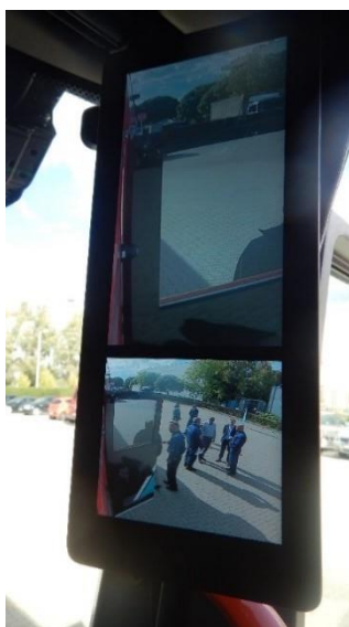
8. számú kép. A külső „visszapillantó” kamerák által a fülkében megjelenített kép (Pántya Péter, 2022).
