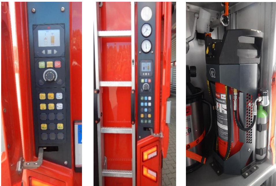
24. - 26. számú képek. Az elektromos működtetésű szivattyú bal és jobb oldali vezérlőpanele valamint a málházott mobil sűrítettlevegős habbal oltó. (Pántya Péter, 2022)
