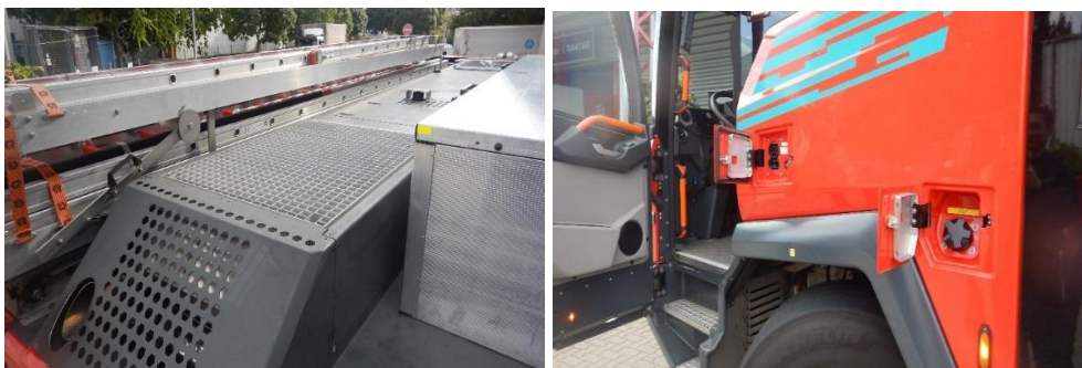
6. és 7. számú képek. A hatótávnövelő dízelmotor hűtője és kipufogó-vege járható védőrácsoszással a jármű tetejének hátsó részén valamint a háromféle tölthetőség kialakítása (Pántya Péter, 2022)
