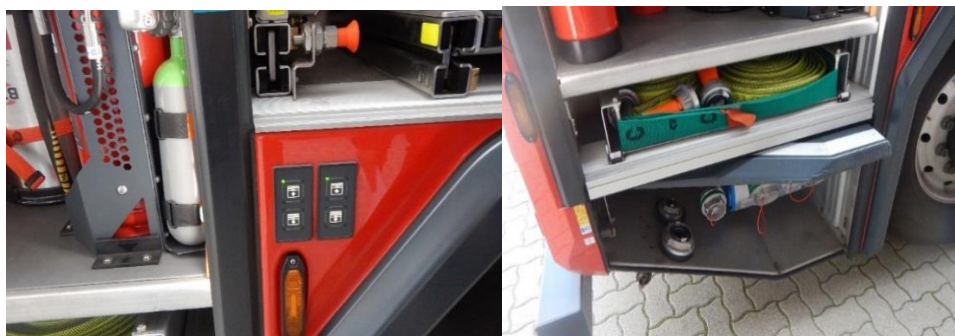
16. és 17. számú képek. A málhatér redőnyének működtető gombjai és az egyik málhatér valamint fedő ajtajának kialakítása. (Pántya Péter, 2022)
