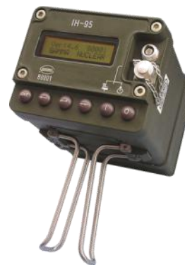
IH 95 sugárszint és szennyezettség mérő
