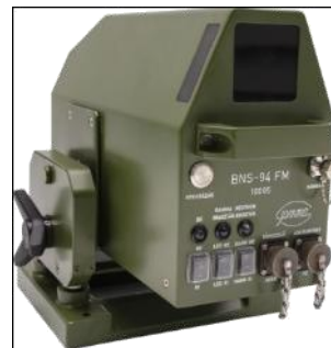
BNS 94FM sugárfelderítő rendszer
