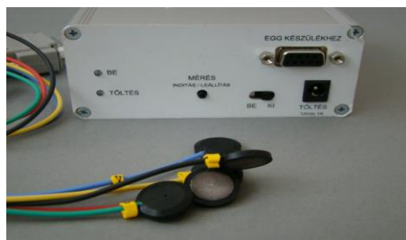
3. és 4. ábra: A 24 órás mérésre is alkalmas EIG készülék (Forrás: A Szerző saját felvétele)
