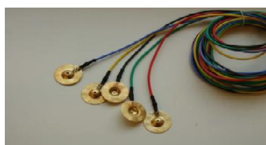
5. és 6. ábra: A testfelületről elvezethető bioelektromos jelek átvitelére szolgáló, elektrolit géllal töltött tányéreelektrodák (Forrás: A Szerző saját felvételei)
