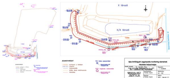
PÓRUSVÍZNYOMÁSMÉRŐ (TALAJVÍZSZINT MEGFIGYELŐ) HELYEK A X./A ÉS A X. JELŰ TÁROZÓTEREKNél 2010. NOVEMBER-2011. NOVEMBER
